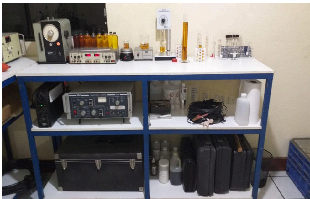
Equipos de medición de tensión interfacial y factor de potencia
