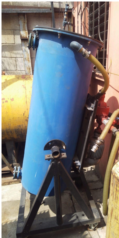
Filtro sílica para regeneración de aceites aislantes
