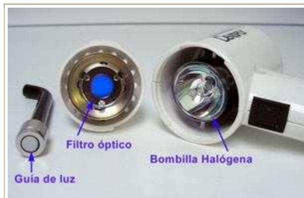
Fig 1: Bombilla halógena y filtro óptico para luz azul.
