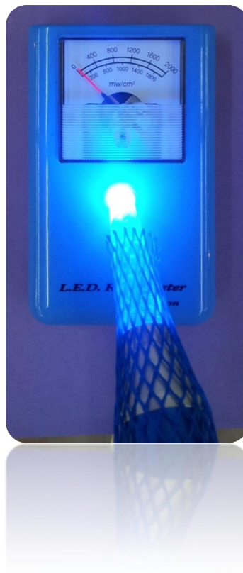
Fotografía 18. Lámpara LED de marca Gnatus modelo Optilight LD Max fue la que registró la menor intensidad en el estudio con 25 \text{ mW/cm}^2 .
