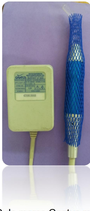
Fotografía 18. Lámpara LED de marca Gnatus modelo Optilight LD Max fue la que registró la menor intensidad en el estudio con 25 \text{ mW/cm}^2 .
