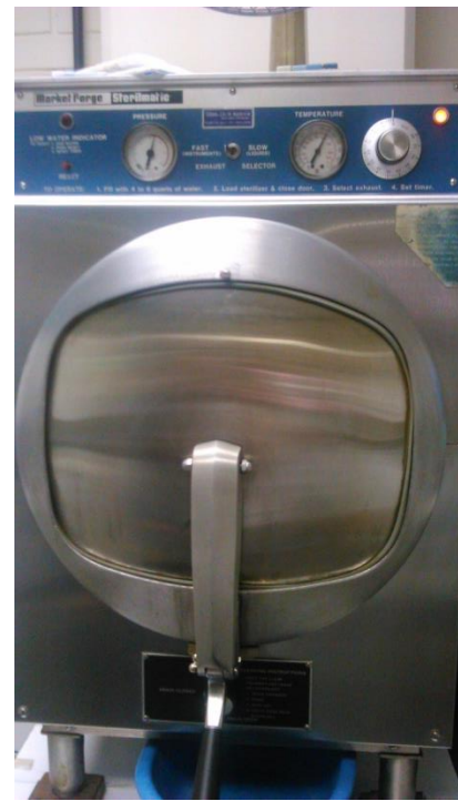
Imagen 2. Autoclave 1 de la Clínica de Cirugía y Exodoncia
