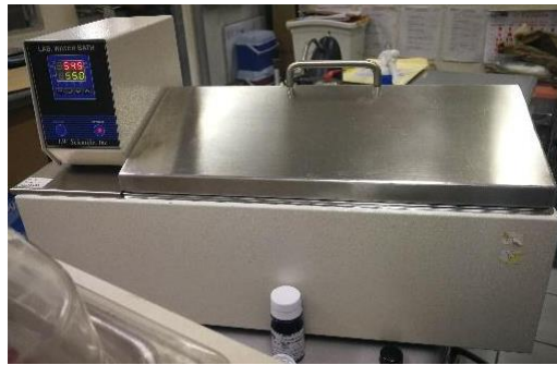
Fotografía 3: Baño de María para la temperatura de 55°C.
