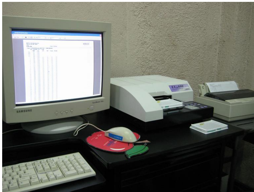
Imagen 4. Lectura de pocillos con filtros de 450nm y 630nm. Cálculo e impresión de resultados. LOA 2008.
