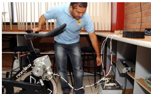
Ilustración 44 Bicicleta estacionaria de ITSL, la cual con ½ hora de pedaleo acumula 120W en las baterías que dirigen esta hacia un transformador. Imagen obtenida de http://www.elsiglodetorreon.com.mx/
