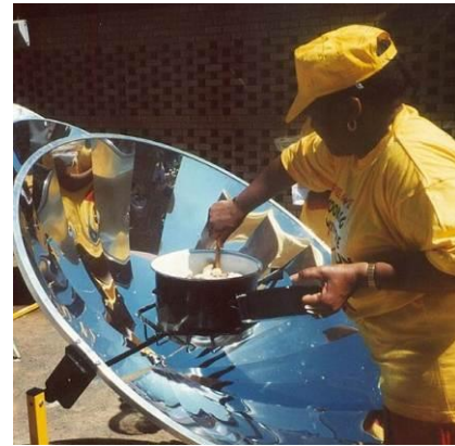
Ilustración 29 Estufa solar de configuración parabólica. Imagen obtenida de http://energiasera.wordpress.com/2010/01/02/las-cocinas-solares-ventajas-y-desventajas/#more-883
