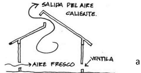
Ilustración 17 Efecto Chimenea. Gráfica realizada por Armando Deffis Casso
