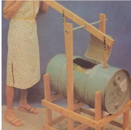
Imagen 83 Lavadoras Manuales fabricadas a partir de toneles y madera. Imagen Obtenida de Revistas ¿Cómo Hacer Mejor?
