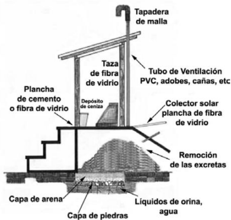
Imagen 85 Letrina de colector Solar (Secado de Heces). Imagen obtenida del Manual de Manejo de Excretas y Aguas Residuales Municipales PROARCA
