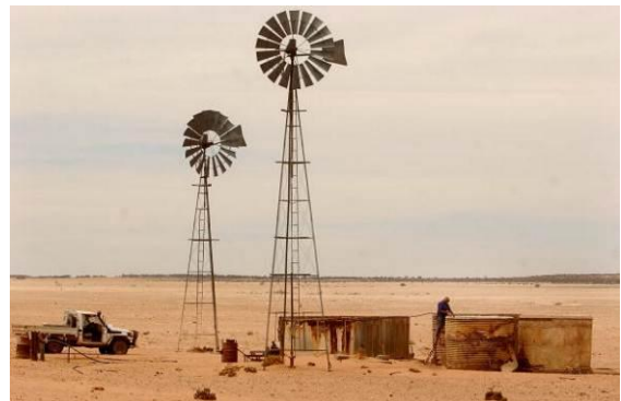
Ilustración 35 Aerogeneradores que a través del viento se obtiene energía mecánica para accionar bomba hidráulica http://energiasera.wordpress.com
