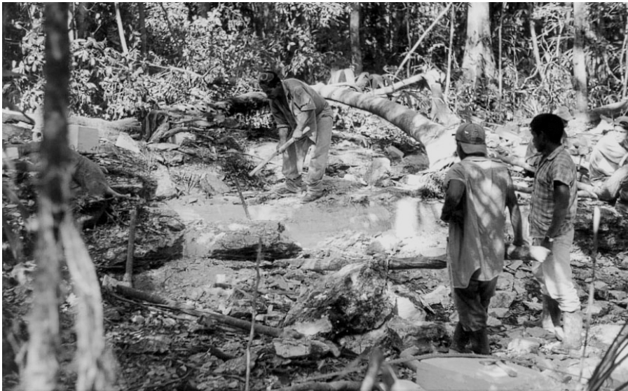
Foto 4: Corte y fractura de una porción de piedra caliza en la cantera del Grupo Ardilla.
