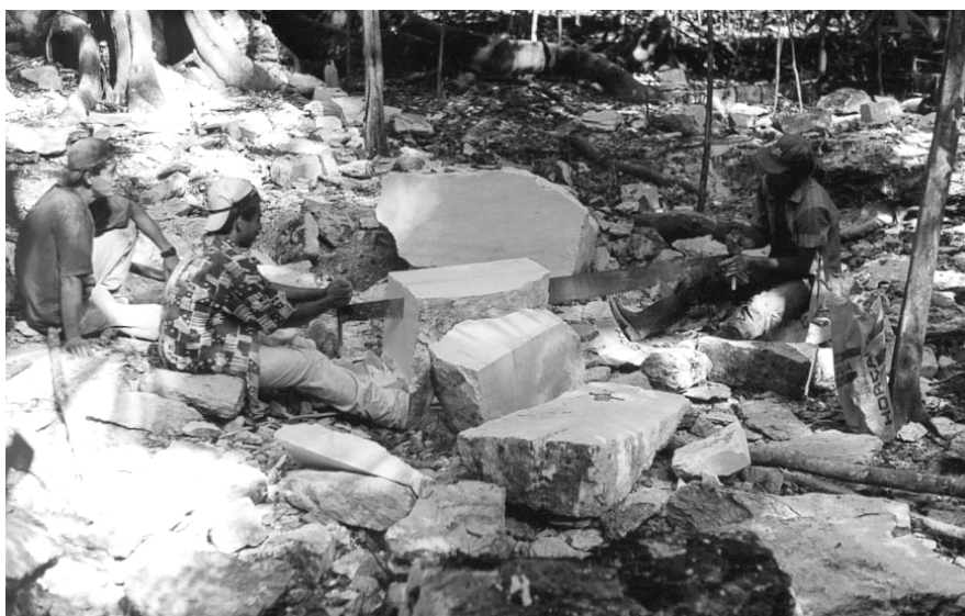
Foto 6: Corte y reducción de una porción de piedra caliza a sillares con sierra "sardina", cantera del Grupo Ardilla.
