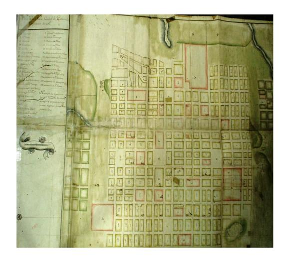
Figura 30. Plano de la Nueva Guatemala de la Asunción, del año de 1783. En este plano se localizan 52 cajas de distribución de agua. Actualmente solo existen 2. Las direcciones donde se localizan es: esquina de 10 calle entre 3 y 2 Avenida y la otra es 1 calle a 100 metros en dirección oeste del templo de Candelaria. AGCA Sig. A1 Leg. 6083 Exp. 55039.
