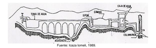
Figura 20. En esta figura se muestra un ejemplo de cómo estaba distribuida la arquitectura hidráulica en Santiago.
