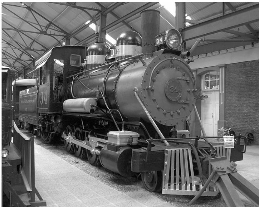
Foto: 16.Locomotora a Vapor fabricada a finales del siglo XIX en EE.UU. Marca Baldwin No. 34 Conocida como “La Presidencial”. En exhibición en el Museo del Ferrocarril. Toma Fotográfica: Noviembre 2006.
