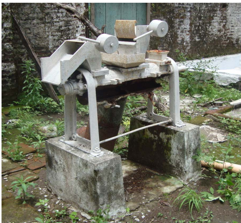
Restos de lo que fue la lavadora mecánica utilizada en la finca en el proceso de limpieza del café.
