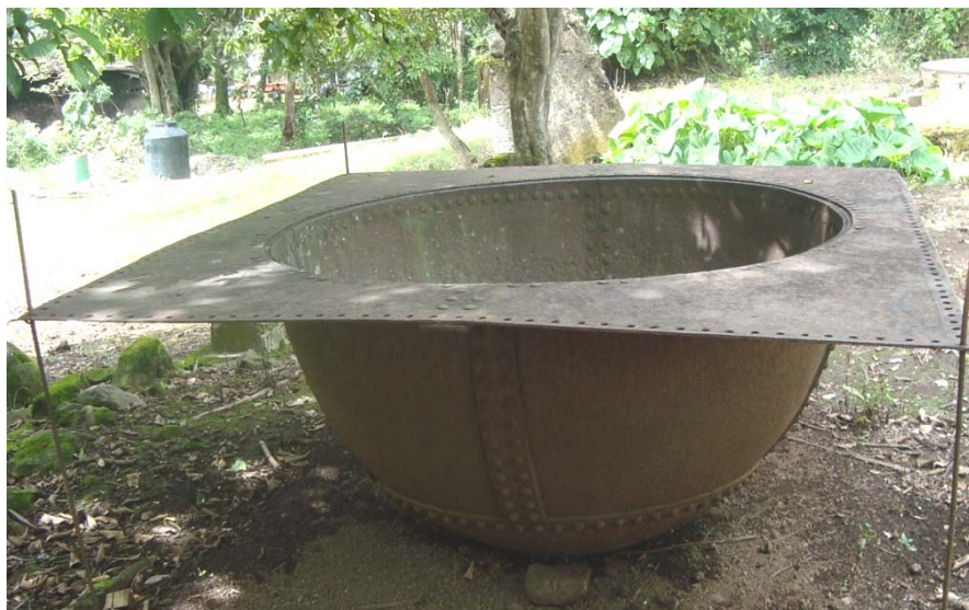
Restos de una paila utilizada para el procesamiento de la panela en Medio Monte.
