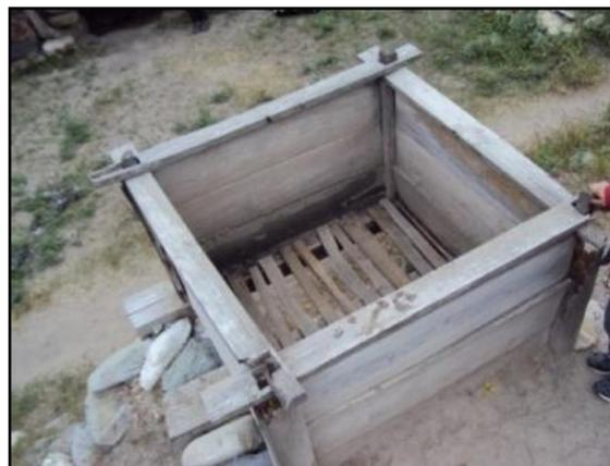
**Figura 18. Cajón de destilado.**
