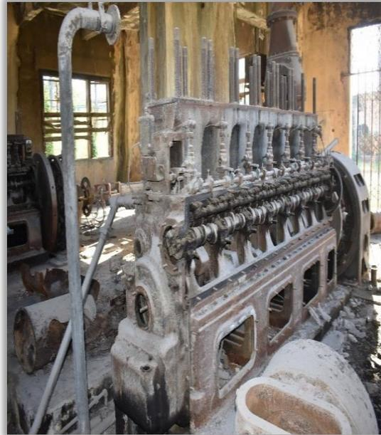
**Figuras 60 y 61.** Izquierda, motor de locomotora diésel *Ingersoll Rand* de 6 cilindros, remanente 1. Derecha, motor de locomotora diésel de 7 cilindros, remanente 2 (fotografías: Tobar, 2019).
