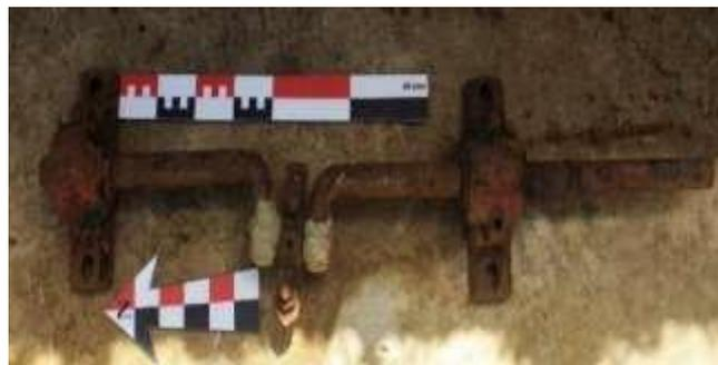
Figura 43. Eje cigüeñal, fotografía de campo 2020.
