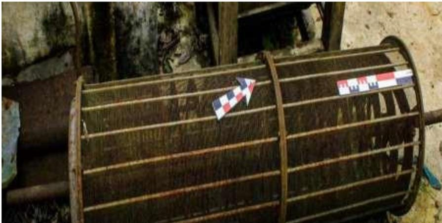
Figura 41. Criba metálica ubicada en beneficio antiguo. Fotografía de campo 2020.
