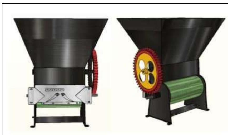
Figura 37. Vista frontal y lateral derecho despulpadora. Dibujo de campo 2020 y dibujo digital por Kevin Caal.
