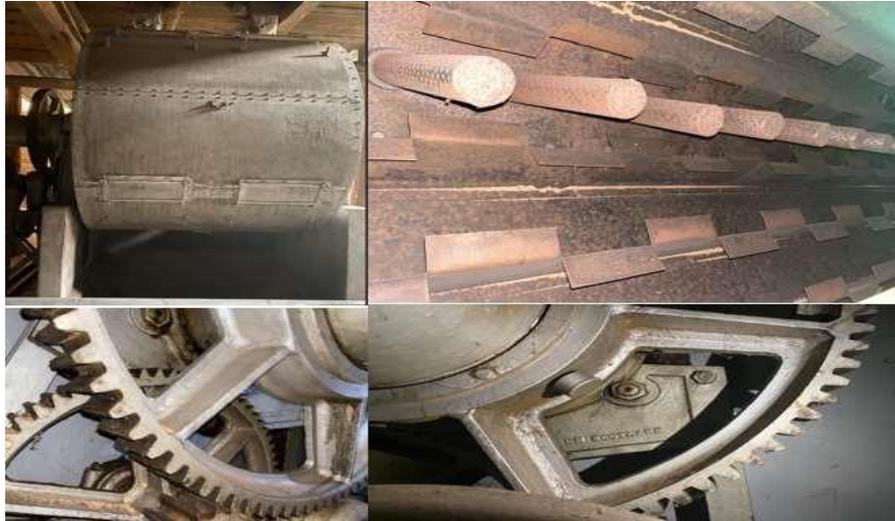
Figura 95. Secadora tipo Guardiola, fabricación del cilindro Talleres Meza, engranajes McKinnon, capacidad 60 quintales, detalles de engranajes y el interior del cilindro giratorio. Fotografía tomada por la autora 2019.
