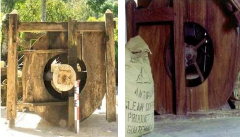
Figura 25. Ventilador de Madera y engranajes metálicos en área de beneficiado antiguo de Finca Chimoté, fotografía de campo 2020. Segunda fotografía tomada de Wagner, 2001, en Historia del Café en Guatemala, en la sección El ciclo de la producción de Café consulta en línea, sin numeración de página.
