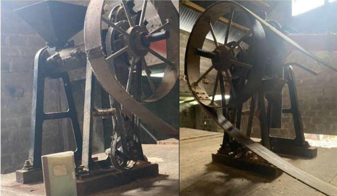
Figura 90. Retrilla reutilizada ubicada en entrespiso de casa de máquinas, vistas laterales. Al pie de la retrilla se puede visualizar el diario de la finca. Fotografía tomada por la autora 2020.
