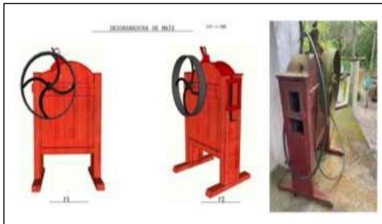
Figura 62. Desgranadora de maíz, localizada en casa patronal. Nótese el cuerpo de madera y partes específicas de metal. Dibujo y fotografía por la autora, dibujo digital por Kevin Caal.
