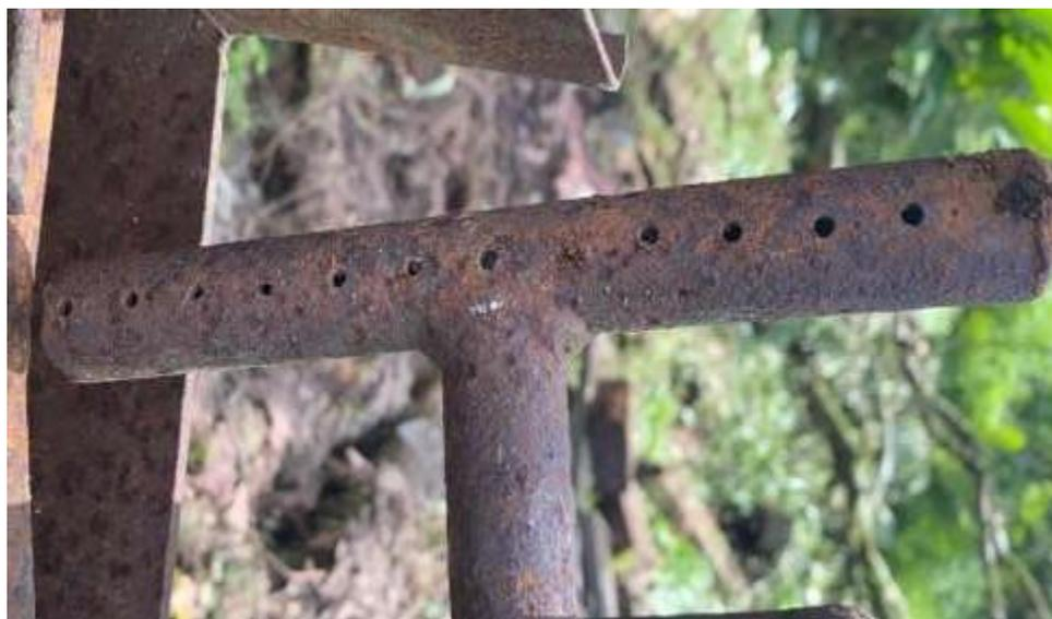
Figura 45. Detalle de los agujeros en serpentines de calor. Fotografía por la autora 2020.
