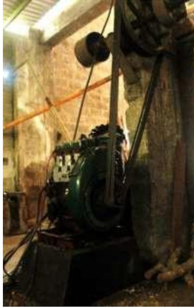
Figura 102. Motor LISTER y árbol de poleas de sistema de secadora 2, fotografía de campo 2020.
