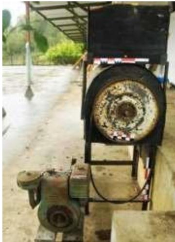
Figura 59. Desgranadora BRIGSS & STRATTON CORP. Con motor. Fotografía tomada por la autora 2020.
