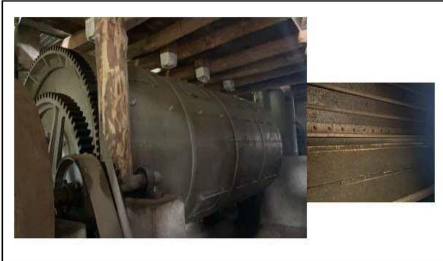
Figura 99. Secadora tipo Guardiola de 120 quintales, nótese el detalle de interior del cilindro.
