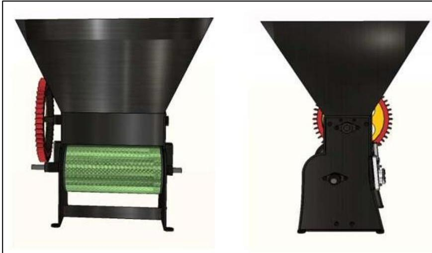
Figura 38. Vista Posterior y lateral izquierdo despulpadora. Dibujo de campo 2020, digitalización Kevin Caal 2022.
