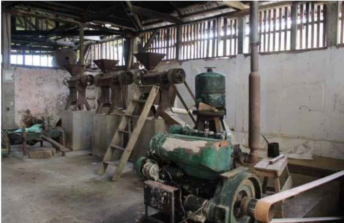
Figura 91. Las 3 retrillas de primera generación en casa de máquinas asociadas a un motor (probablemente) "Lister" en finca Urías, Antigua Guatemala. Fotografía tomada por E. Carpio, 2019.
