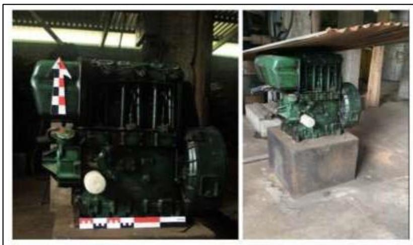
Figura 92. Motor LISTER de 3 cilindros. Notar que el techo de la casa de máquinas tiene agujeros y es necesario protegerlo directamente con lámina de zinc. Fotografía de campo 2020 y 2021.
