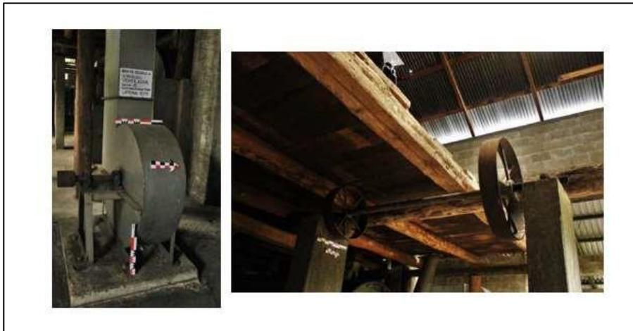
Figura 101. Ventilador del sistema de secadora 2 y el árbol de poleas, fotografía de campo 2020.
