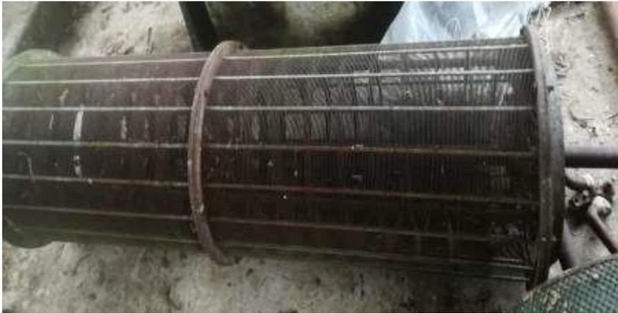
Figura 40. Criba metálica ubicada en beneficio antiguo. Fotografía de campo 2021.
