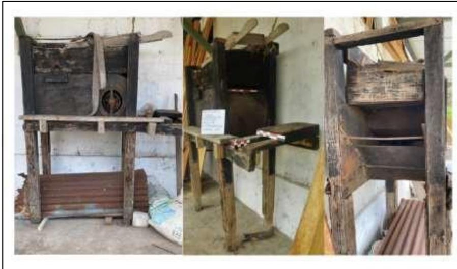
Figura 60. Desgranadora de maíz, vista frontal y laterales. Fotografía de campo 2020.
