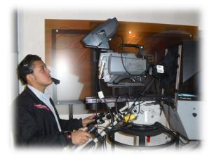
Considerándolas como los ojos a través de los cuales se puede llevar al televidente al lugar de los hechos, el tipo de cámaras que se utiliza actualmente en la unidad móvil vía Microondas es la cámara de Estudio Sony 537 y la cámara utilizada para el sistema Web Sat es XD Cam HD Sony.
