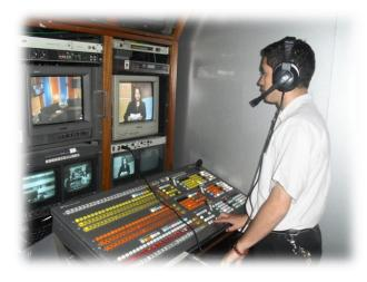
Equipo utilizado como mezclador de imágenes tiempo real, con dispositivos llamados buses en los que se manipular puede una señal conocida como previa y una llamada señal al aire, siendo esta la parte final de la transmisión; existiendo el mercado en
