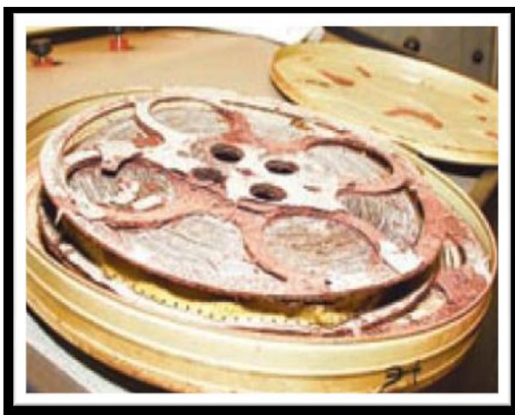
Fotografía No.25 Rollo de film con deterioro. Archivo CUET (2008).
