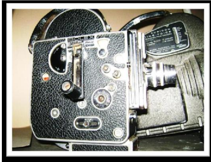
Fotografía No. 3 Cámara Bolex H16, cuerda carga de chasis, torreta de 3 lentes montura C. Con lente zoom Berthiot 17/85mm F2.8, Teleobjetivo Ivar 150mm fijos Paillard 10mm o 25 mm F1.8, fijo Angenieux 25mm, Fijo Cook 16mm. Archivo CUET (2010).
