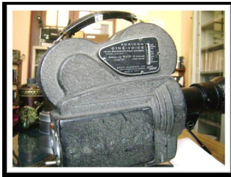
Fotografía No. 2 Cámara Estadounidense Auricon Cine-Voice 16 mm Sound on film Camera, modelo cm-72A, 15 watts Bach, Auricon, Inc. Bوليوود 38 California Hech. Archivo CUET (2010).
