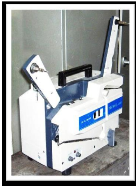
Fotografía No. 6 Tele cine ELMO Trv-16H, convertidor de películas a video superior de 16mm. Equipado con cámara de video CCD de 410 mil pixel produce más de 450 líneas horizontales de TV. Archivo CUET (2010).
