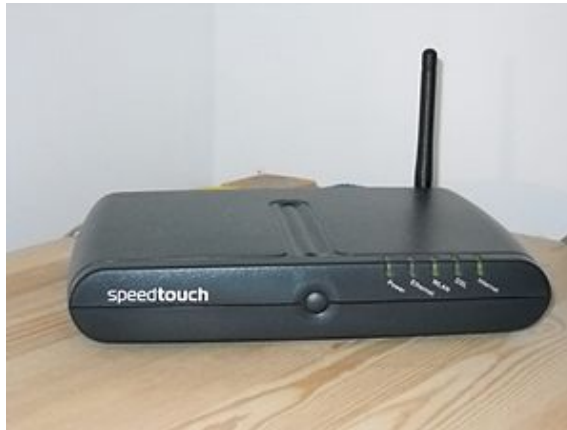
Fig. 2 Router de banda ancha, elaboración propia
