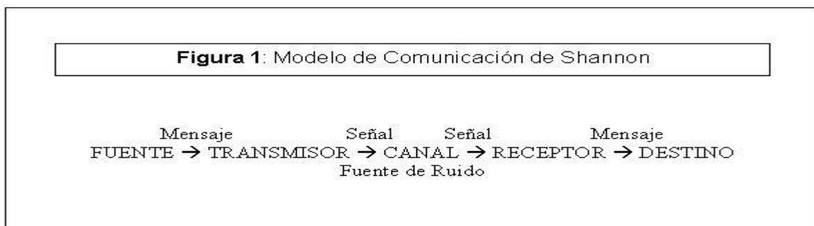
Fig. 1—Diagrama esquemático de un sistema de comunicación general Shannon (1948) indica que si nos situamos en este modelo, los elementos de la
