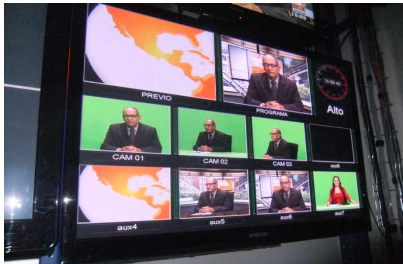
En la imagen se observa la composición Chroma Key en el momento en el que el noticiero de TN23 está al aire.
