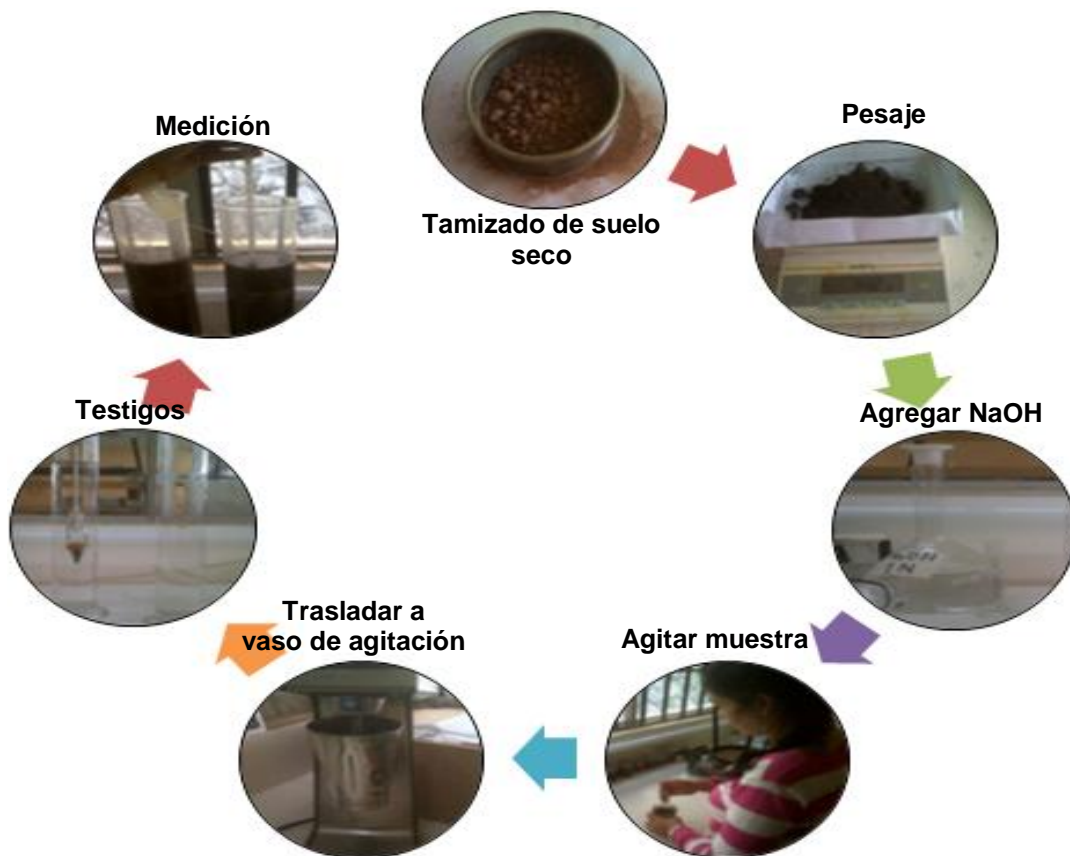
FIGURA 3 PROCESO PARA DETERMINAR TEXTURA (MÉTODO BOUYOUCOS)
