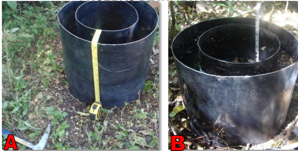
A. Punto 6 Vel. Infiltración 1,23 cm/hr
