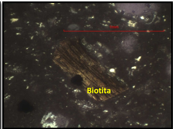
Fotografía 4: cristal de Biotita, Vista XPL.
