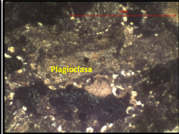
Fotografía 2: Plagioclasa alterada propiliticamente, Vista XPL.
