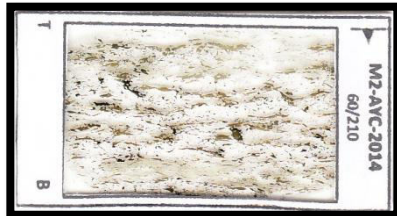
FOTOGRAFÍA NO. 4 SECCIÓN DELGADA DE GNEIS BIOTÍTICO.
