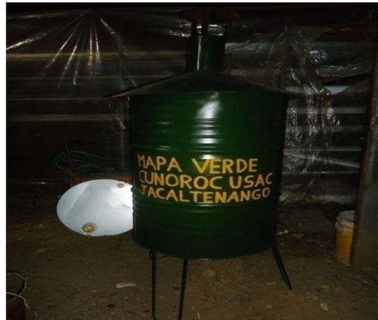
Imagen 09. Incinerador elaborado con material reciclable.
