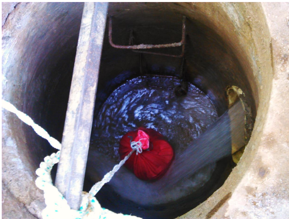
Figura 11. Aforo de las aguas residuales en la última caja de registro previa descarga, en el sector La Floresta, Nuevo Progreso, San Marcos.
