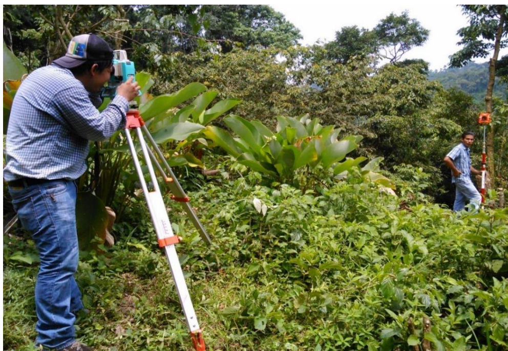
Figura 9. Levantamiento topográfico del sitio sugerido para la ubicación del humedal artificial para el tratamiento de aguas residuales municipales del punto de descarga ubicado en el Sector La Floresta, Nuevo Progreso, San Marcos.
