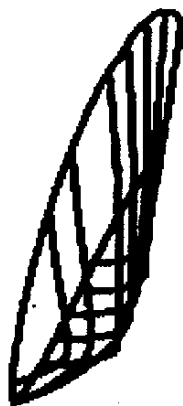
Tipo de parrilla desviadora "Super shooter" usada en DET rígido, en las pesquerías de camarón en Guatemala.
