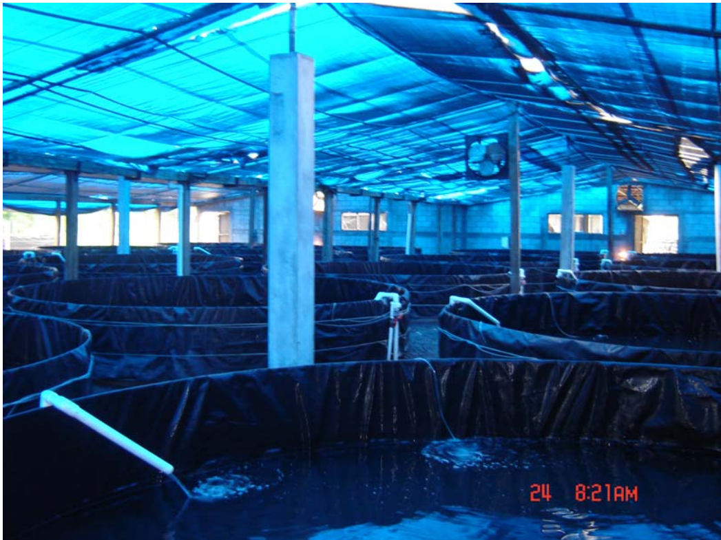
Figura 12. Tanques circulares donde se manejan los reproductores para ser madurados gónadalmente.
