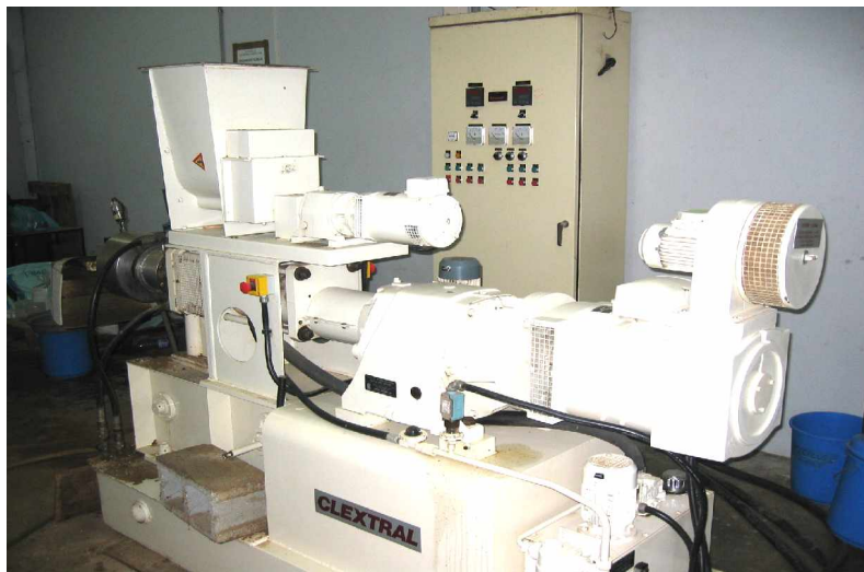
Figura No 14. Extruder semi-industrial de la casa Clextral modelo BC 45
