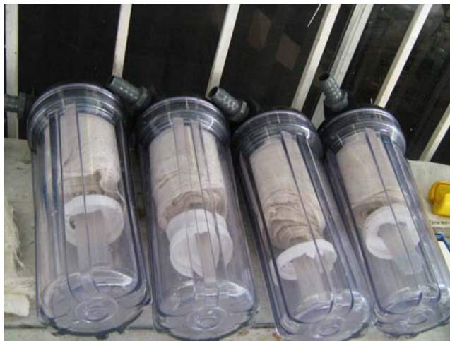
Figura No. 5: Sistema de filtros de gasa en la entrada de tanques.
