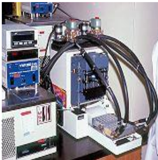
Figura No. 12: Primer modelo de equipo para la PCR.
