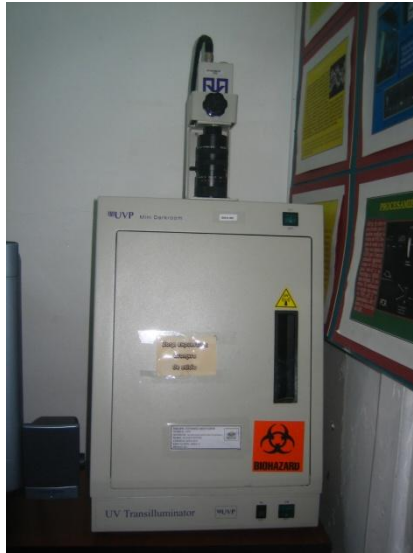
Figura No. 20: Cámara de luz UV, utilizada para visualizar el resultado de la electroforesis.
