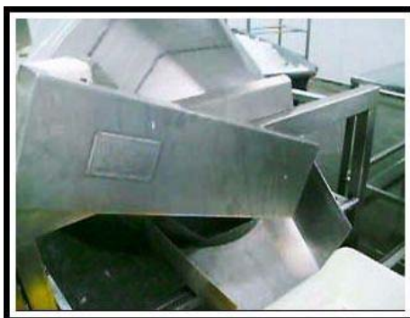
FIGURA No. 38. Chiller o tanque de enfriamiento del área de clasificado (Trabajo de campo, 2010).
