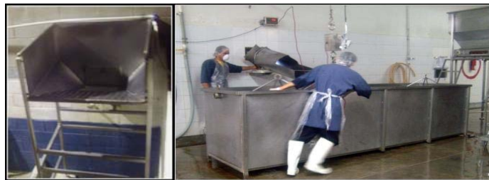
FIGURA No. 15. Tolva externa y tanque de recepción. (Trabajo de campo, 2010).
