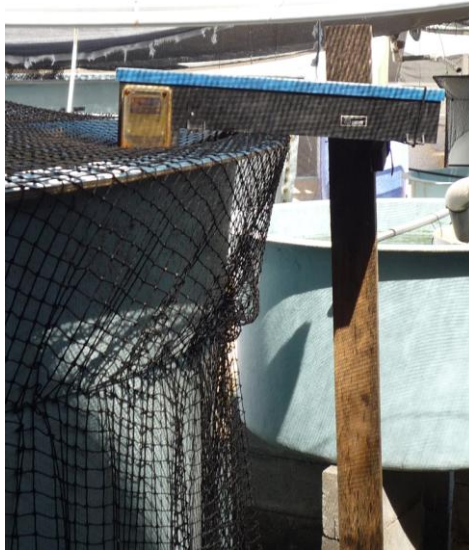
Figura No. 16. Alimentador automático para alimentación de Corvinas (Trabajo de Campo, 2010)
