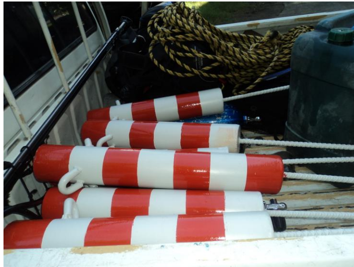
Figura No. 9. Testigos de azolvamiento (Trabajo de campo, 2011)
