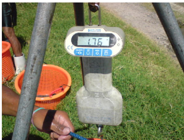
Figura No. 21. Balanza digital, tarada con el peso de una cubeta en Kilogramos (Trabajo de campo, 2011)
