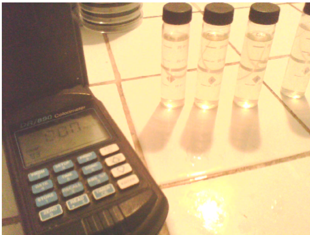
Figura No. 18: Muestras de agua del sector 3 y equipo, para comprobación de sulfuros. Fuente: Trabajo de campo (2011).
