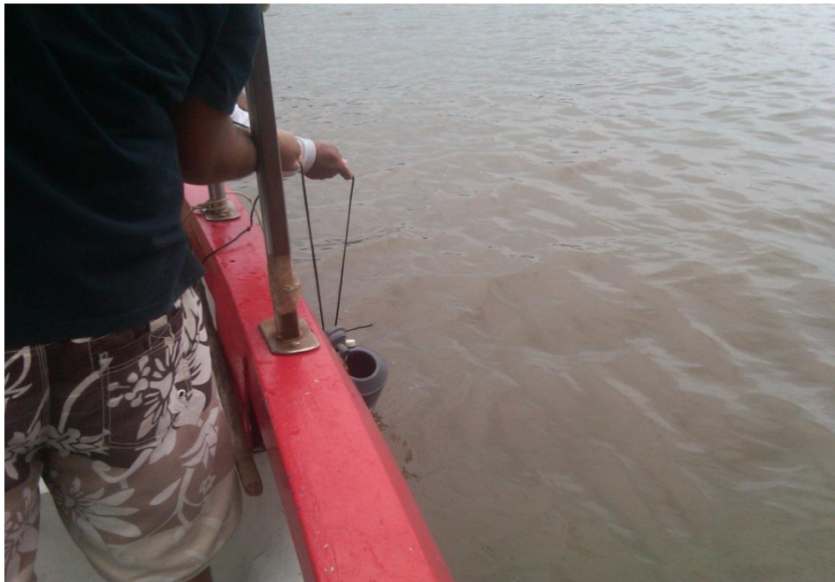
Figura 17. Uso de la botella de niskin. Fuente: Propia.
