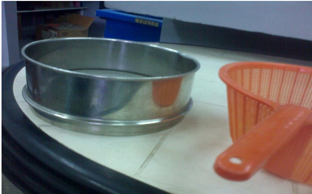
Figura 9. Tamiz de 850 um. Fuente: Propia
