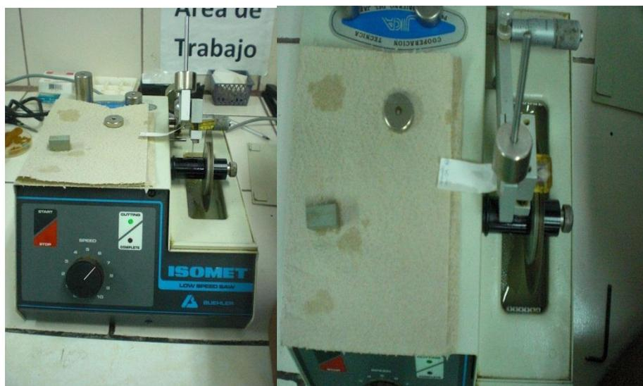
**Figura No. 9** Corte de otolito al micrótopo (Trabajo de laboratorio, 2011).
