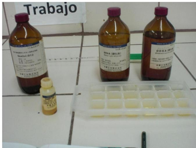
**Figura No.7** Materiales para la elaboración de resina (Trabajo de laboratorio, 2011)
