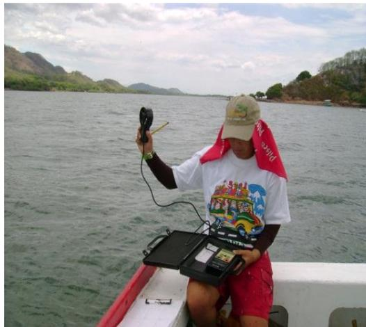
**Figura No. 24** Anemómetro (Trabajo de campo, 2011).
