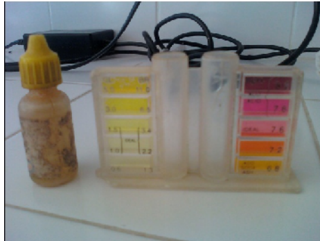
Figura No. 15. Medición de cloro en la cisterna (Trabajo de campo, 2011).
