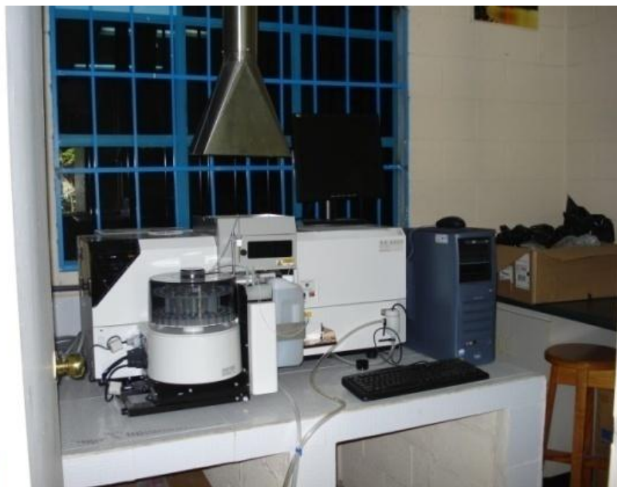
Figura No. 6. Equipo de Absorción Atómica, Espectrofotómetro de CEMA (Trabajo de campo, 2009).
