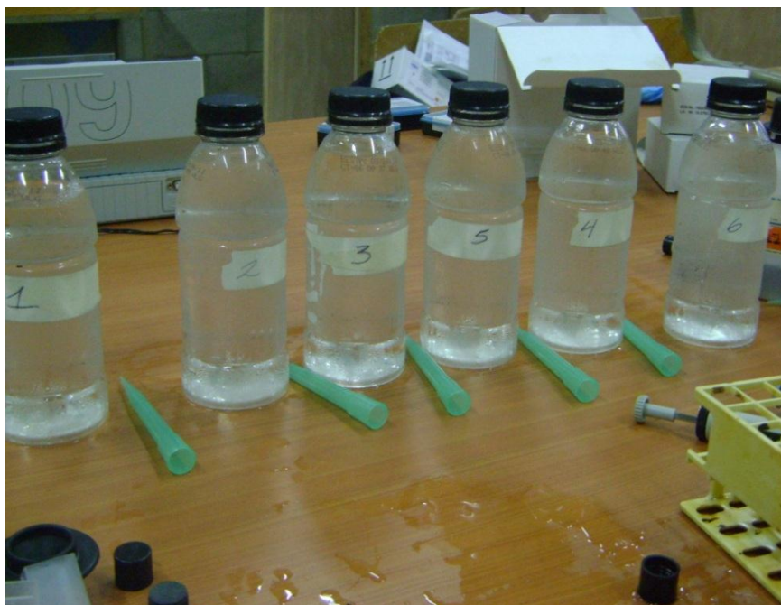
Figura No. 4. Muestras de agua por pozo (mensual) para análisis de parámetros fisicoquímicos (Trabajo de campo, 2011).
