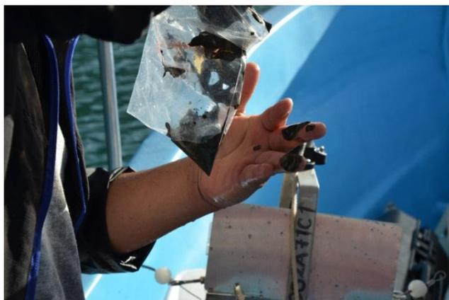
**Figura No. 14** Toma de submuestra de sedimento para análisis granulométrico (Trabajo de campo, 2014).
