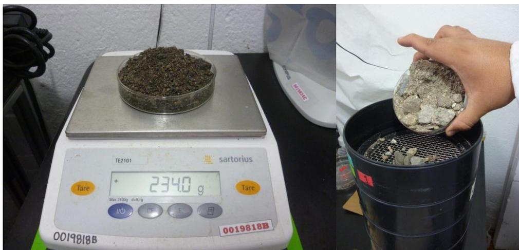
**Figura No.23** Pesaje y separación de las partículas de sedimento de acuerdo a su tamaño (Trabajo de campo, 2014).
