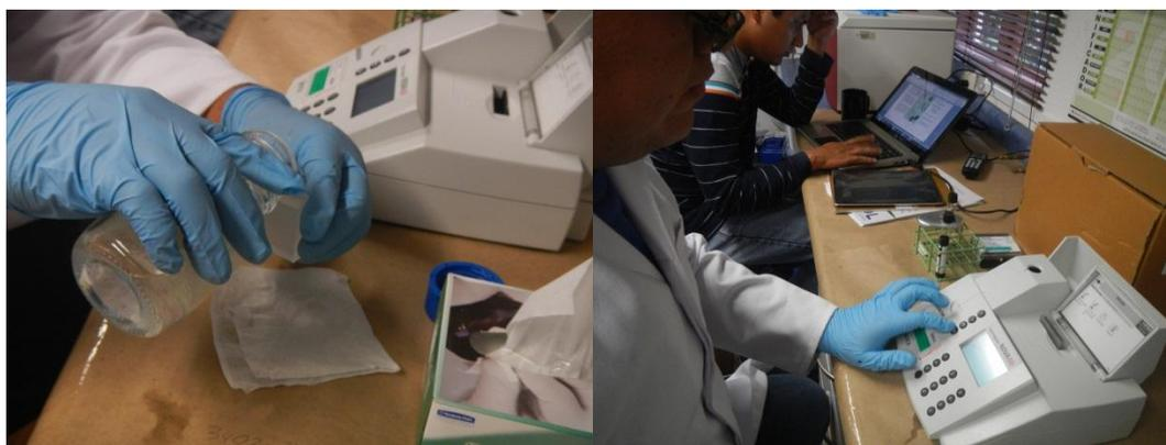
**Figura No.21** Determinación de la turbidez (Trabajo de campo, 2014).
