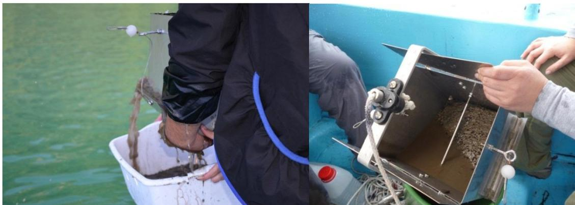
**Figura No. 13** Colecta de muestra de sedimento con una draga tipo Ekman (Trabajo de campo, 2014).
