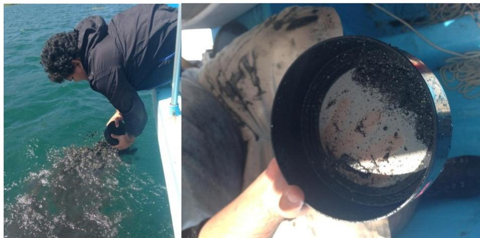
**Figura No.15** Tamizaje *In situ* de la muestra de sedimento (Trabajo de campo, 2014).
