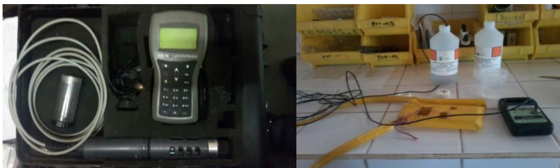
Figura No. 6 Equipo de medición de parámetros físico-químicos in situ (Trabajo de campo, 2014)
