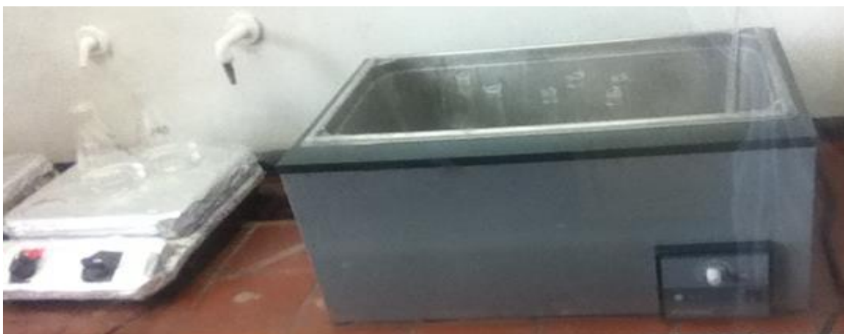
Figura No. 11- Planchas de calentamiento y baño maría para digestar muestras de metales.
