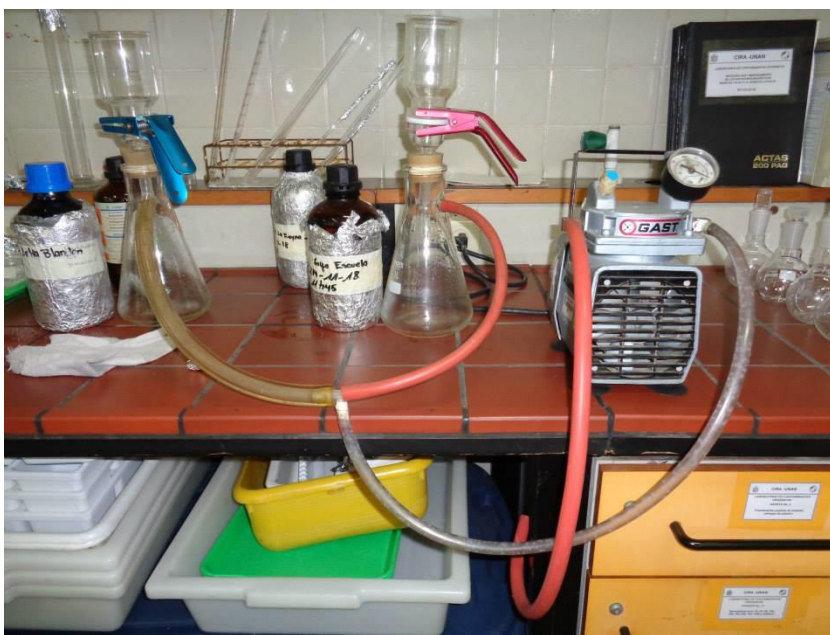
Figura No. 10- Sistema para extraer triazinas
