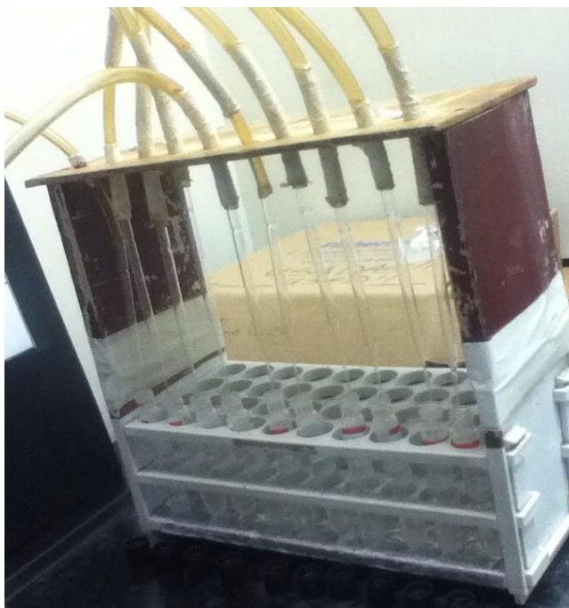
Figura No. 11- Reconcentración de analitos con gas nitrógeno.
