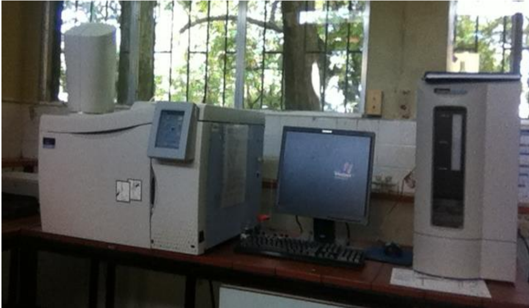
Anexo No. 1- Cromatógrafo de gas CLARUS 500 GC con generador de hidrógeno.
