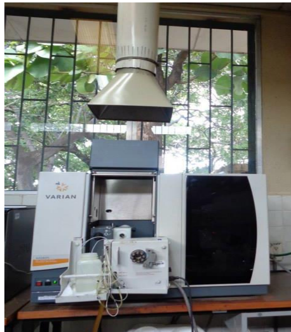
Figura No. 14- Espectrofotómetro de absorción atómica VARIAN modelo DUO AA240 FS con horno de llama.
