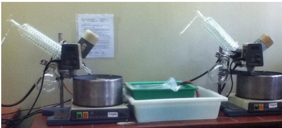
Anexo No. 10- Sistema de baño maría, rotavapor y condensador para reconcentración.
