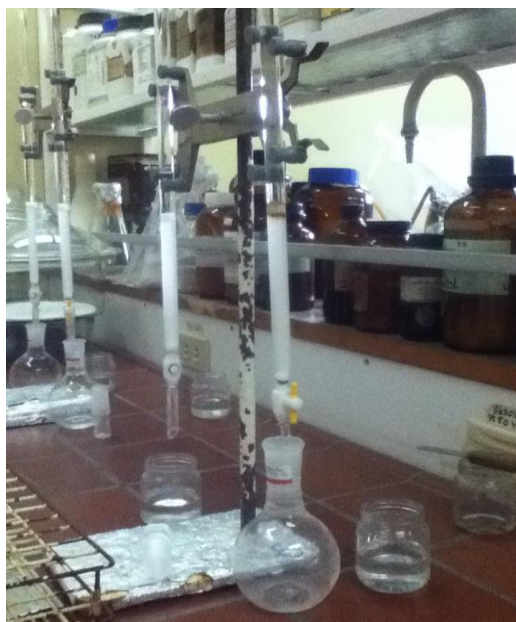
Figura No. 9- Limpieza de hidrocarburos en columna
