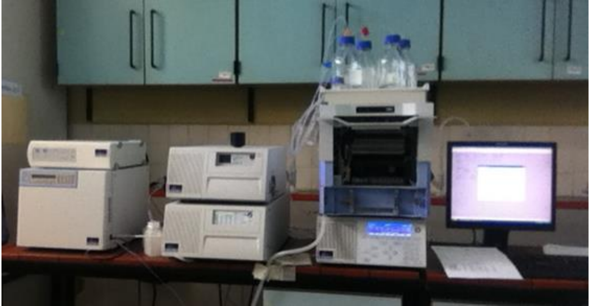
Anexo No. 3- Cromatógrafo líquido (HPLC) marca Merck-Hitachi, modelo D-7000 con detector de arreglo de diodos con lámpara UV y visible y detector de fluorescencia.
