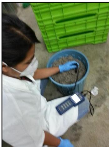
**Figura No. 8.** Medición diaria de pH con potenciómetro
