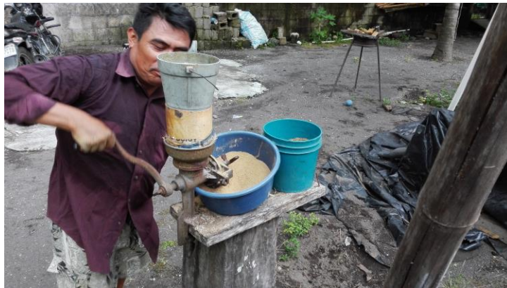
Figura No. 56: Trabajador moliendo alimento de tilapia
