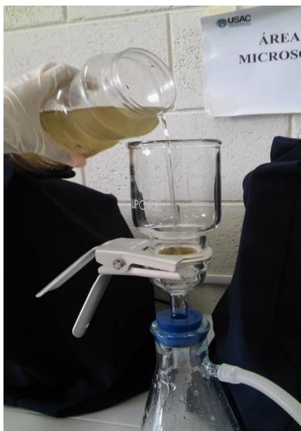
**Figura No. 9.** Filtrado de muestras de agua para análisis fisicoquímicos (Trabajo de campo, 2015).
