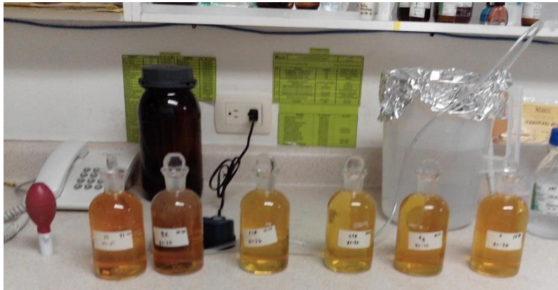
Figura No. 6 Método de Winckler azida para DBO_5 .
