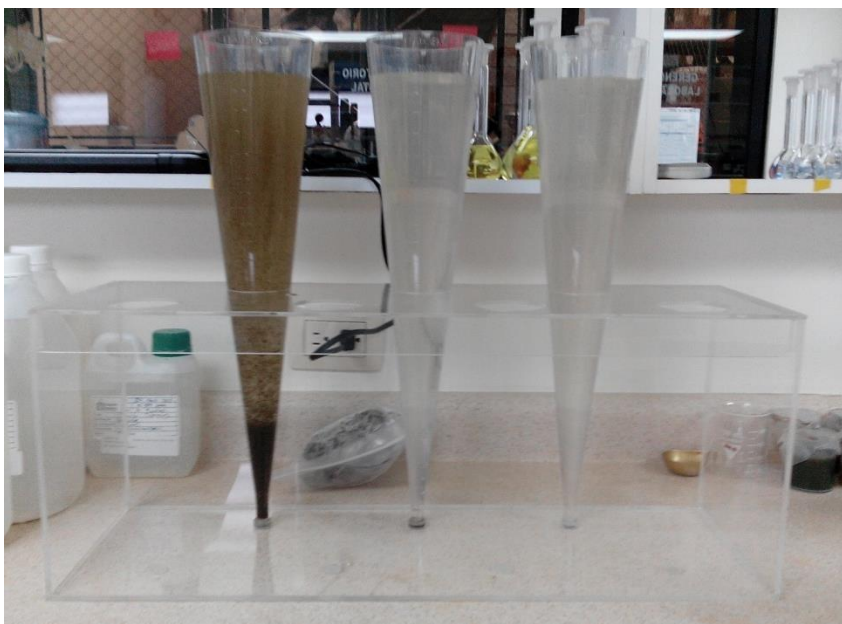
Figura No. 7 Determinación de sólidos sedimentables por medio de conos de Imhoff
