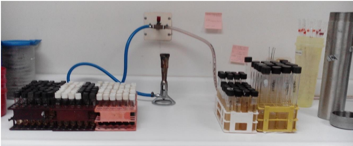
Figura No. 10 Análisis microbiológico para la determinación del grupo Coliforme por la técnica de fermentación en tubos múltiples
