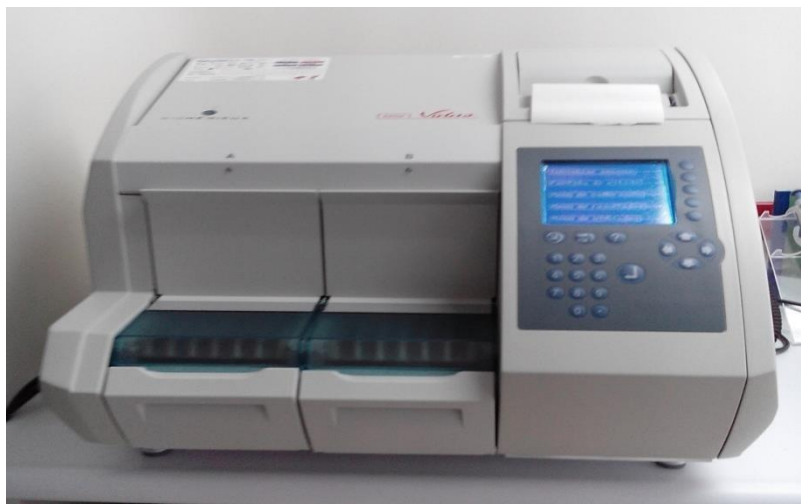
Figura No. 12 Inmunoanalizador multiparamétrico mini VIDAS
