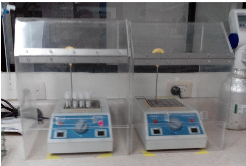
Figura No. 5 Muestras colocadas en digestor a 150°C
