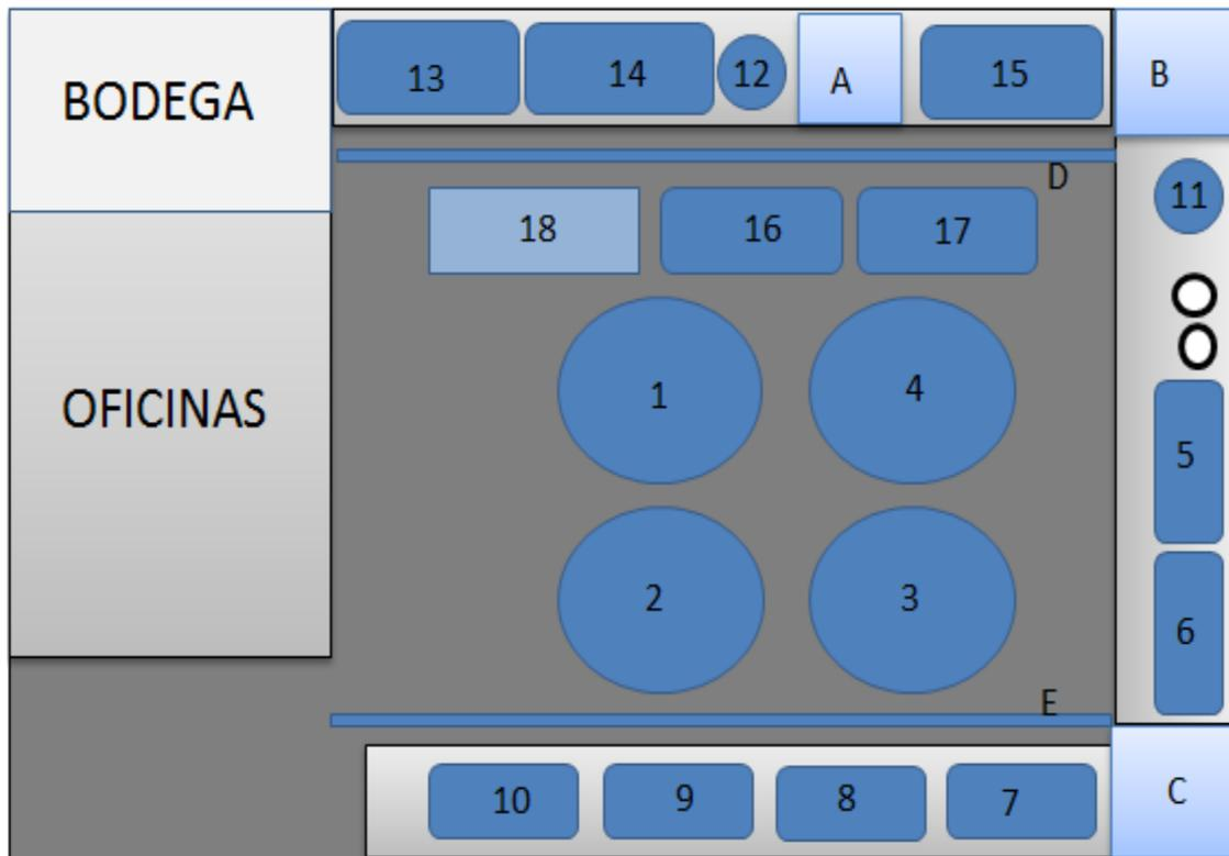
1-4, Estanques de Larvicultura o Maduración de agua. 5-10, Estanques de Aclimatación de Reproductores. 11-12, Estanques de Alimentación. 13-17, Cultivo de Semilla. A-B-C, Fregaderos. D-E, Canal de desagüe. 18, Estanque para nuevo sistema Upwelling.
