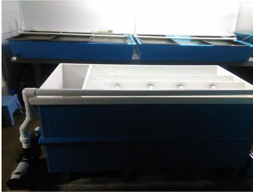
**Figura No. 23** Tanque para los nuevos sistemas upwelling.
