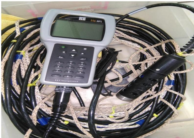
**Figura No. 24** Sonda Multiparametrica marca YSI 556MPS utilizada en las giras de campo.
