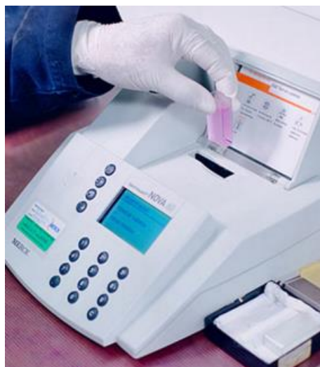
Fig. No. 18 Equipo certificado de Merck (NOVA 60) para análisis colorimétricos (Trabajo de campo, 2015)
