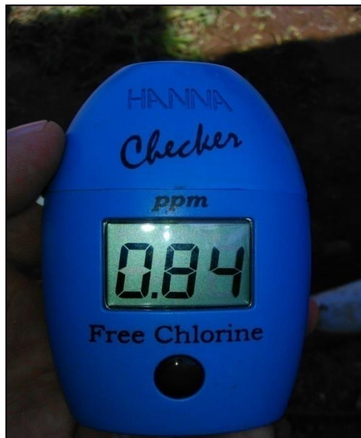
Figura No. 51. Cloro residual in situ (Trabajo de campo, 2015)
