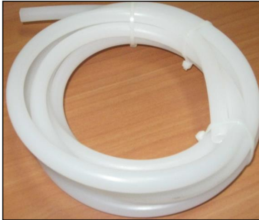
Figura 32. Manguera utilizada en entrada y salida de la bomba (Trabajo de campo, 2015)
