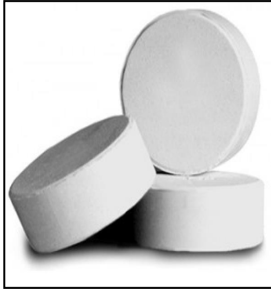
Figura No. 4. Estado sólido del cloro (Quimiur, 2007)
