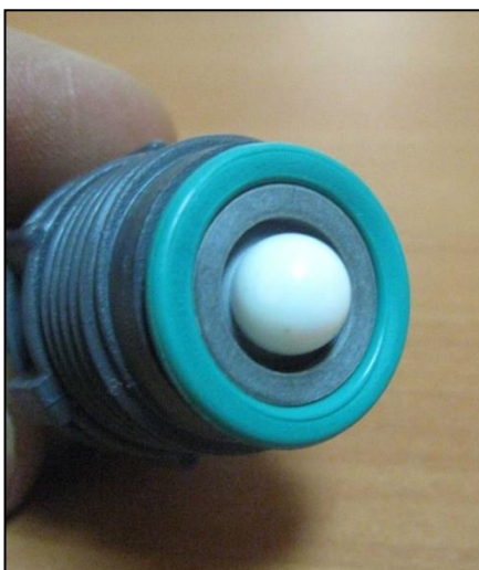
Figura No. 39. Cheques dentro de la válvula (Trabajo de campo, 2015)
