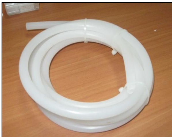
Figura No. 11. Manguera sistemas succión e inyección (Trabajo de campo, 2015)
