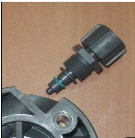
Figura No. 38. Pieza completa de la válvula (Trabajo de campo, 2015)
