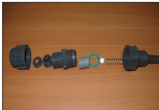
Figura No. 14. Punta de Inyección (Trabajo de campo, 2015)
