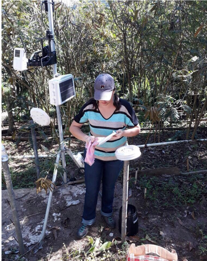
Figura 4. Limpieza de estación meteorológica AMSA 9 Magdalena Milpas Altas
